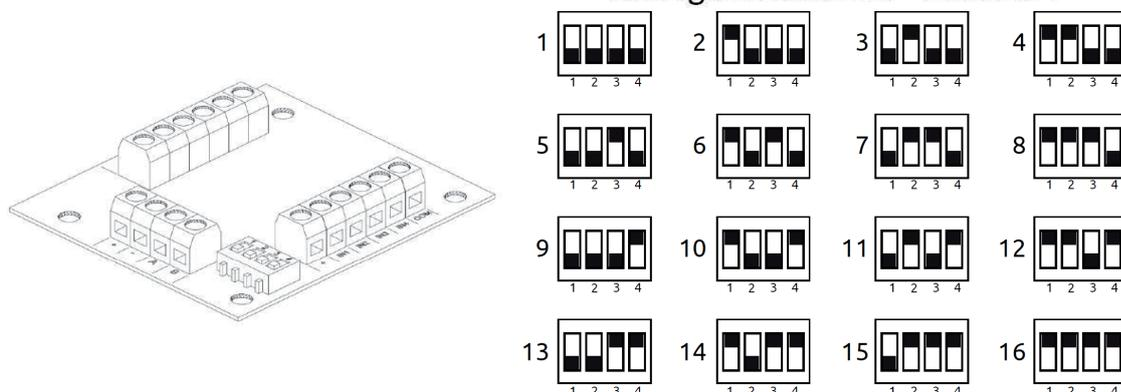
**N.B.:** in CONFIGURAZIONE 1 TUTTI I DIP IN OFF
