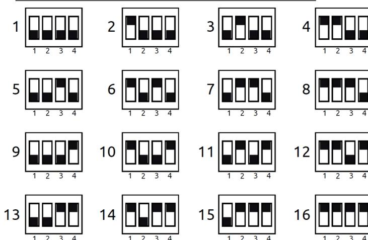
**N.B.:** in CONFIGURAZIONE 1 TUTTI I DIP IN OFF
